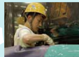
旋转轴承使用安装工具“拧紧机”。拧紧数据保存在服务器内，保证和管理力矩。
