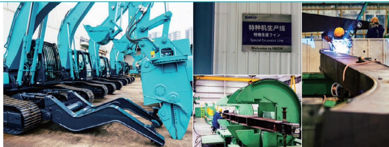
照片左 / 装载夹臂和液压剪等特殊零件的汽车解体机。照片中上 / HKCM有生产特殊规格机专用生产线。照片中下是固定加长臂挖掘机的大臂的夹具。参与加工的人员都是高端技术专家。
