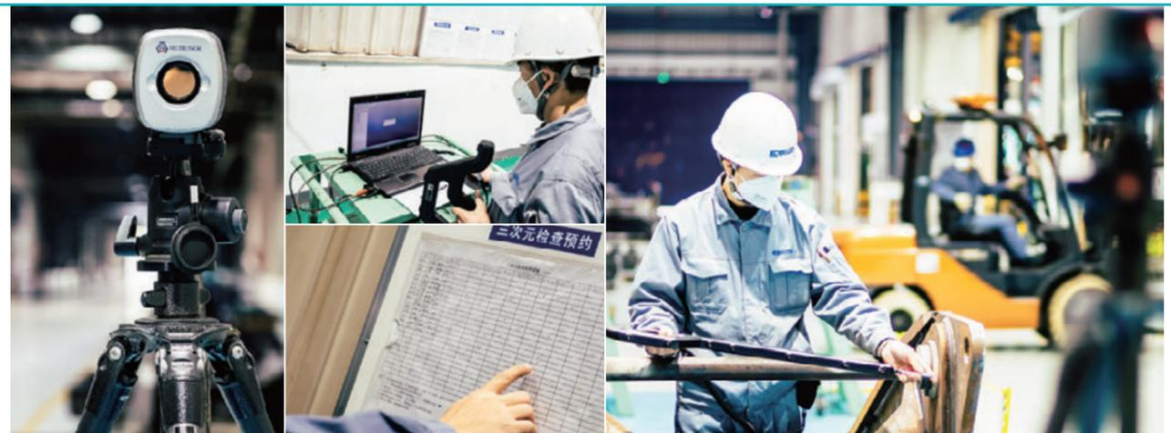
熟练的检测人员测量时将感应器校准到必要的点坐标，通过相机（照片左）将点坐标输入电脑，由此可测定形状复杂的结构物体，这就是三坐标测量仪。日本生产工厂使用的也是同样的仪器。
