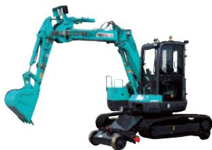
轨道挖掘机。维护线路作业专用机。
