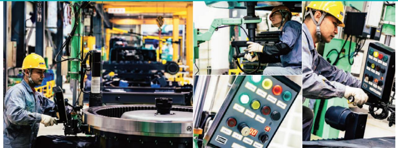
蓝红灯显示拧紧程度，无遗漏拧紧结束作业时，装置发出声音可进行确认。HKCM导入了4台自动拧紧机。照片左是旋转轴承，中上是拧紧配重螺栓时的场景。
